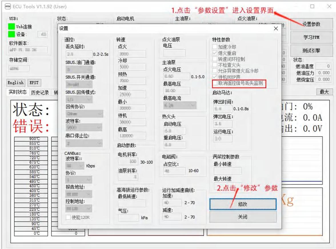
打开 ECU Tools (User) 软件，点击“设置参数”，在“特性参数栏”，勾选“取消遥控信号丢失监测”即可。**注意：**勾选“取消遥控信号丢失监测”后，ECU 接受信号中断后发动机持续执行最后一个指令，不勾选“取消遥控信号丢失监测”则发动机接受信号中断 2.5s 后，发动机直接停车，且随即进入冷却状态。
