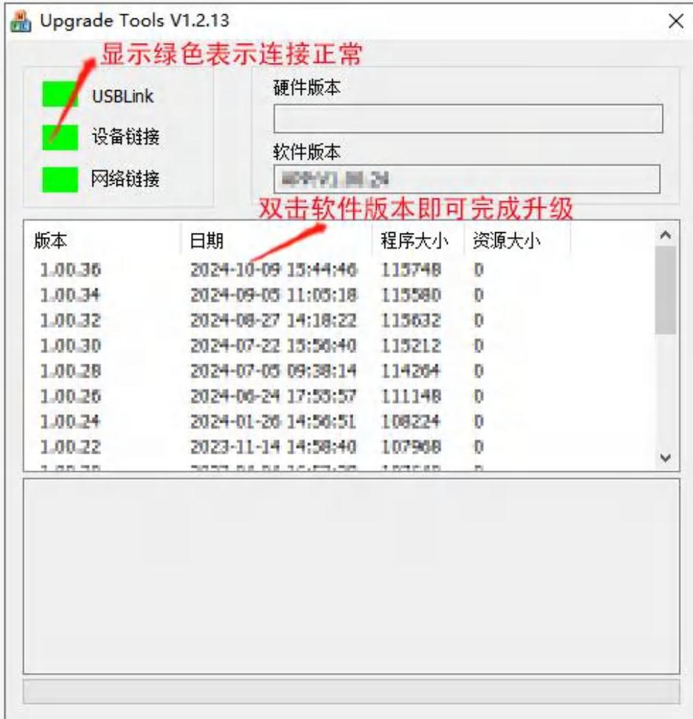
1、硬件准备好后，登录玄云网站 <http://www.swiwin.com> 下载 Upgrade Tools 升级工具。
