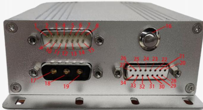
1-15 号针脚为 RS232/RS422 接口, 用于连接外部信号控制设备, 可与 RS232 接口或 RS422 接口进行连接
